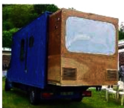
Un caisson se déploie à l'arrière afin d'agrandir la capacité du camion. Cet aménagement a été effectué par les élèves du lycée Boismard.
